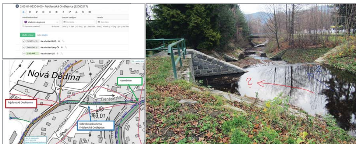
Obr. 4.9 Ilustrace nesouladu mezi vedením dolního toku Frýdlantské Ondřejnice v ZABAGED® (resp. MŽP) a CEVT
