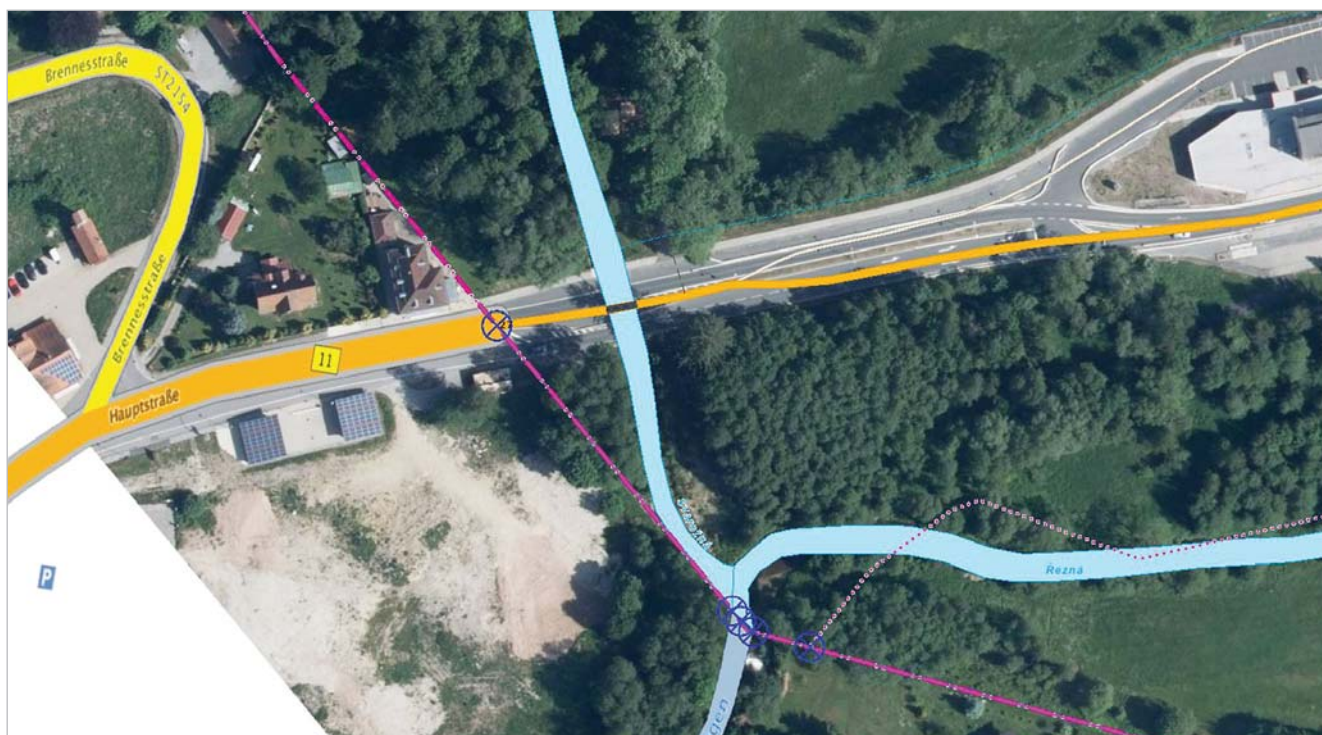
Obr. 4.10 Ilustrace spojení vybraných vrstev WMS Atkis-Basis-DLM bavorského LDBV a dat ZABAGED®, modré kruhové značky vyjadřují odsouhlasené hraniční styčné body
